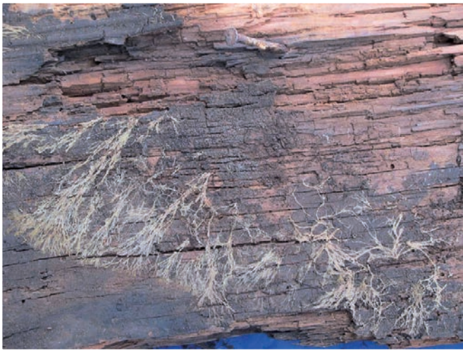
Bild 5 | Das Werkzeug kann in das vom Echten Hausschwamm geschädigte Holz mühelos eindringen.
